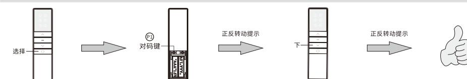
遇阻反弹/遇阻停止互换：默认开启遇阻反弹模式，重复操作是遇阻反弹与遇阻停止相互切换。（默认反弹约30cm，切换后遇阻停止不反弹）
