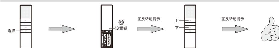
点动/连动模式互换：电机出厂默认为连动模式，切换为点动模式后，长按住【上行键】或【下行键】约2s电机一直连动运转。
