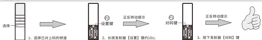
**复制：**为已经对码的电机新增一个发射器：
