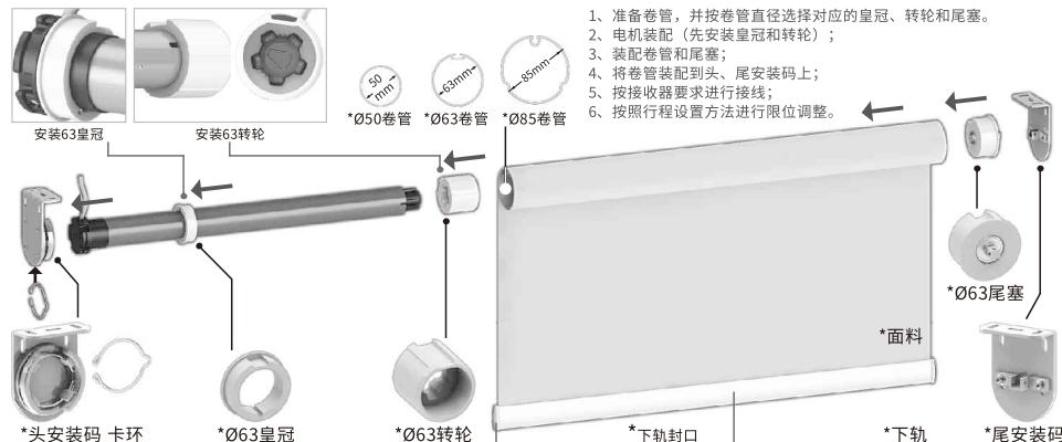
注：正确安装卷帘后面料应贴着窗户上下卷动
