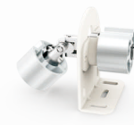
D26158 Φ50-135度万向节S- 升降专用-铝 内置滚珠轴承, 采用 Φ24mm, 加强 万向轴心制作, 打 破行业高负载难点 可承重100 kg
